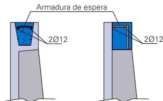
EN EL CASO DE MUROS MUY ALTOS, Y PREVIO AL RELLENO DE TRASDÓS, ES CONVENIENTE HORMIGONAR UN ZUNCHO EN CORONACIÓN PARA EVITAR LOS POSIBLES DESPLAZAMIENTOS DIFERENCIALES DE LOS PANELES, QUE PUDIERAN PRODUCIRSE DURANTE LA FASE DE RELLENO.
